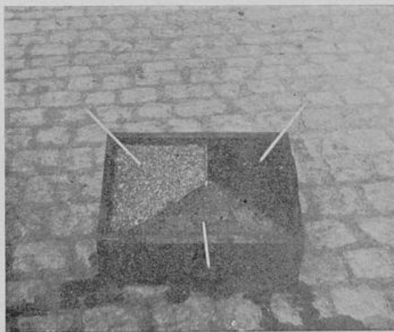
Verschiedene Erwärmung des Sand-, Lehm- und Tonbodens durch Sonnenbestrahlung.
