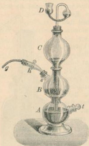
Fig. 23. Kipp'scher Schwefelwasserstoffapparat. Seite 73.
