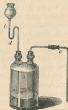
Einfache Apparate zur Entwicklung des Schwefelwasserstoffgases.
