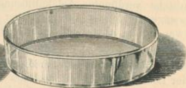
Fig. 54. Grösseres Glasgefäss mit senkrechter Wandung zum Abdampfen von Benzin und Petroläther.
