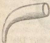
Gekrümmte Al-longe zur Verlängerung des Abflusses des Kühlrohrs im Liebig'schen Kühler.
