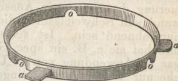
Eiserner Ring als Retortenunterlage bei der Destillation über freiem Feuer.
