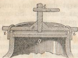
Verschluss der eisernen Blase im Durchschnitt.
