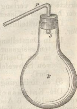
Kolben mit Kork und aufgesetztem Abzugsrohr.
