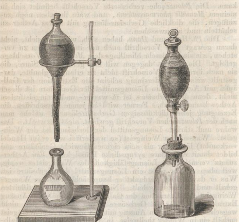
Extraktionsvorrichtungen behufs Darstellung der Gerbsäure aus Galläpfeln. Stechheber mit Korkstopfen auf einem Stativ ruhend. Scheidetrichter mit eingeschlifffenem Stopfen und Hahn.
