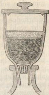
Durchschnittszeich- nung eines beschick- ten Deplacirungs- trichters aus Steingutmasse.
