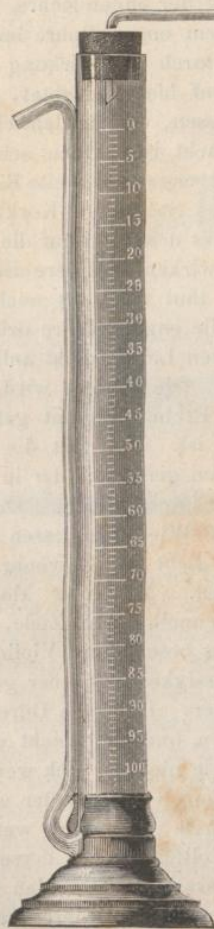
Gay-Lussac's Bürette mit Fuss und Blasrohr.
