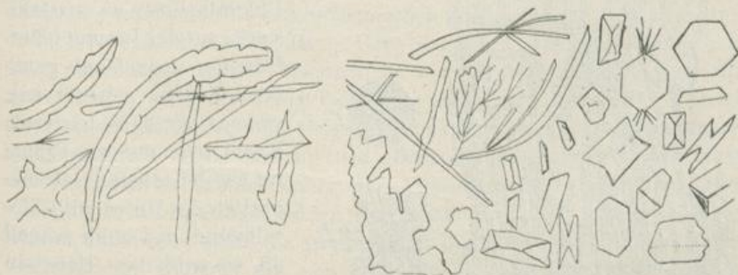
Fig. 41. Sublimat reiner Zitronensäure (Citraconsäureanhydrid) links. Sublimat des Fruchtfleisches der Zitrone, rechts; durch die mitgerissenen Wasserdämpfe ist das Anhydrid überwiegend in Citraconsäure übergegangen (Tunmann).
