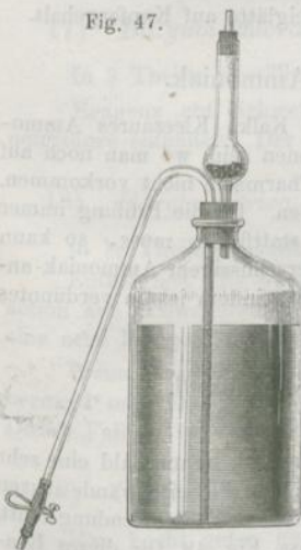
Aufbewahrungsgefäß für Aetzkali und Aetznatron mit Ausflussheber.
