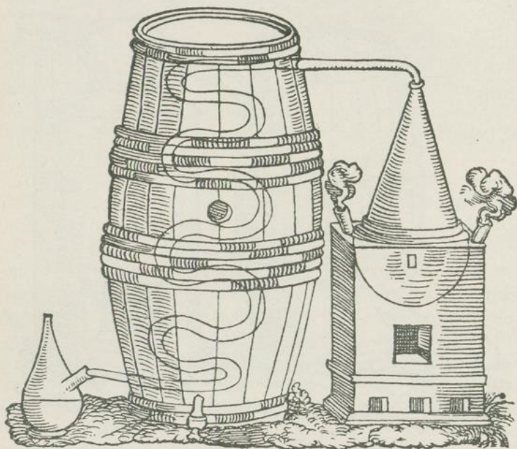
fig. 77. Destilliergerät nach einem Holzschnitte vom Jahre 1567.
