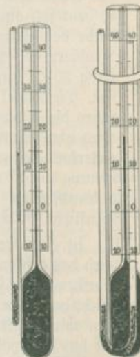
Fig. 14. Fig. 15. Zur Bestimmung des Schmelzpunktes. \frac{1}{2} natürl. Größe.
