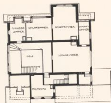
ARCH. H. POELZIG • • GRUNDRISS VOM HAUS POELZIG IN BRESLAU: ERD- UND OBERGESCHOSZ • (VGL. SEITE 25 UND 26)
