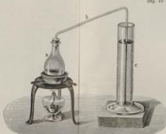
Fig. 4. Apparat zur Bestimmung der latenten Wärmefunktion.
